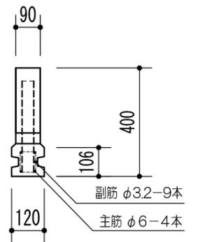
腰掛柱の土に潜る控部分の長さは標準600mmですが最長900mmまで伸ばして製作可能
